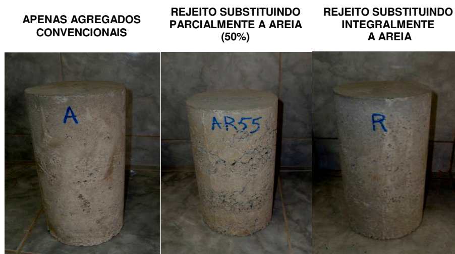
Figura II.3 - Exemplos de corpos de prova com agregado.
