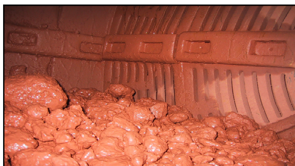
Figura III.2 - Interior do moinho de bolas em moagem a úmido. Fonte: ALUNORTE (2008).
