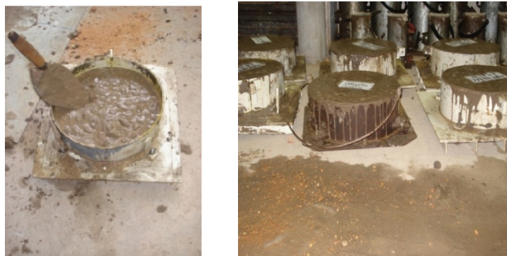
Figura 5.7 - Moldagem dos discos para abrasão.
