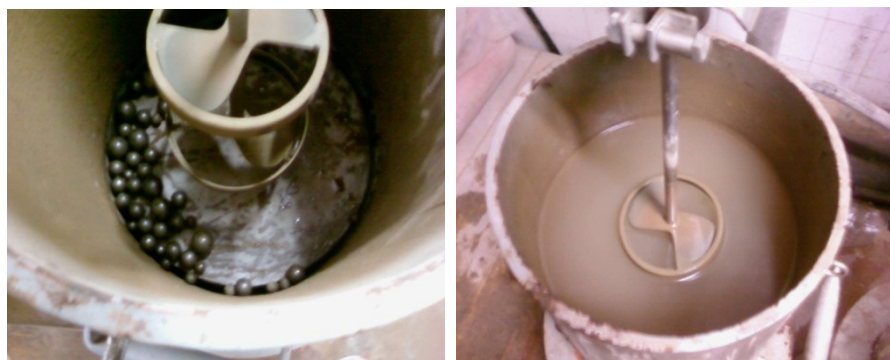
Figura 5.8 - Ensaio de abrasão hidráulica.
