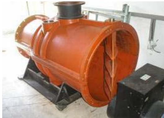
**Figura 5.3.b** - Turbina hélice -
