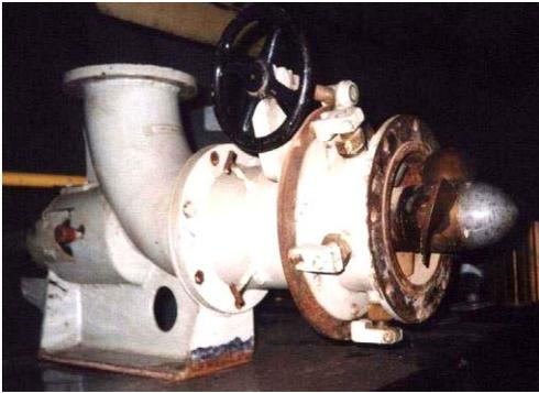
**Figura 5.3.c** - Modelo reduzido de turbina hélice do tipo tubular, com tubo de sucção desmontado para visualização do rotor (LHPCH - UNIFEI).
