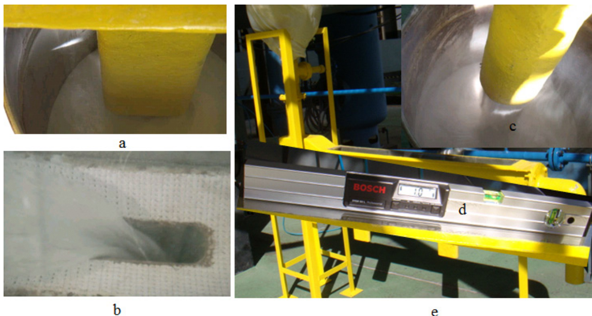
Figura 4.28 – a) formação de calço hidráulico de alumina fluoretada na primeira descarga do transportador no balde com capacidade de 20 L; b) alumina fluoretada fluindo semelhante à água no transportador pneumático fluidizado em queda livre na primeira descarga do mesmo; c) descarga na última saída no balde sobre a balança eletrônica; d) medidor eletrônico de inclinação; e) transportador pneumático fluidizado de 1,5m com três saídas.
