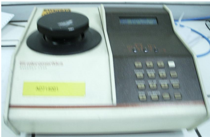
Figura 2.1 – Foto picnômetro a gás hélio – fonte: Albras.
