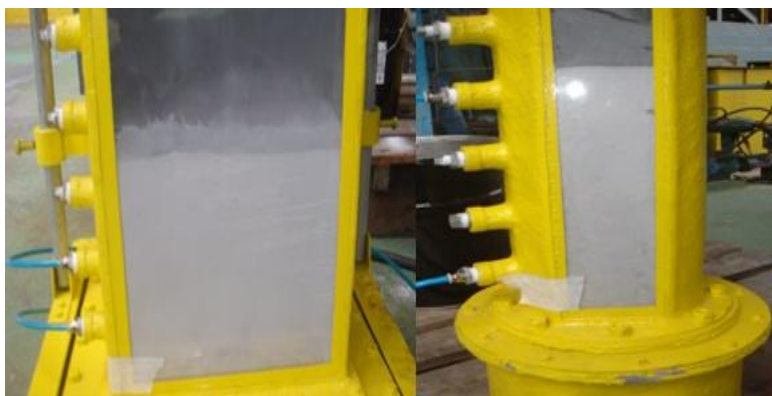
Figura 4.1 – Permeâmetros usados no laboratório de fluidização da Albras para estudo da velocidade mínima de fluidização.
