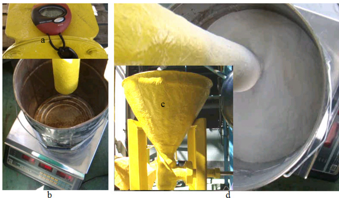
Figura 4.29 – a) Cronômetro com precisão de centésimo de segundos; b) balança eletrônica com precisão de 1 g; c) moega de abastecimento do transportador pneumático fluidizado; d) balde com capacidade de 20 L.
