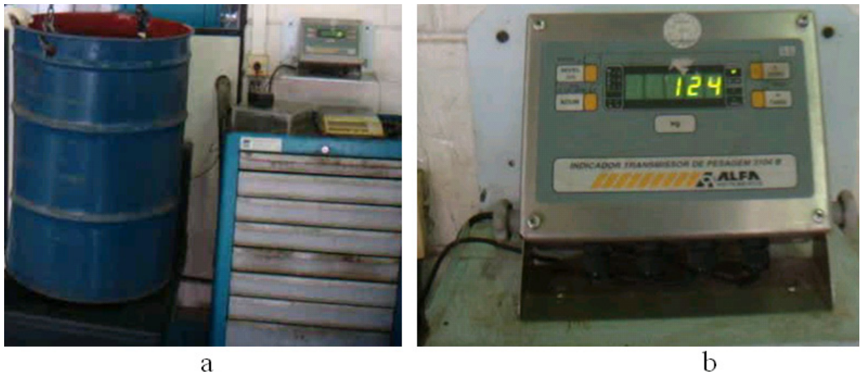
Figura 4.34 – Medição da vazão mássica ar - alumina fluoretada no escoamento no transportador pneumático fluidizado no intervalo de 1 minuto; a) tambor de 200 L.
