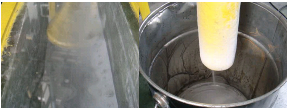
Figura 4.31 – escoamento transportador fluidizado inclinado a 0° e vazão volumétrica
