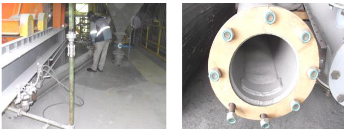
Figura 3.13 - Tubo fluidizado metálico de 8”/3,78 metros ; inclinação 2,2° capacidade de transporte (101,68 t/h – 120 cm / min ) de pó de crosta coletada pelo FM 213007 da Albras.
