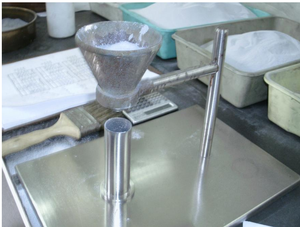
Figura 2.2 - Aparato para determinação da massa específica aparente não vibrada do material particulado (amostra).
