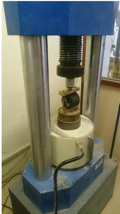
Figura 3.1 - Configuração do ensaio de resistência a tração realizados nesta pesquisa.
