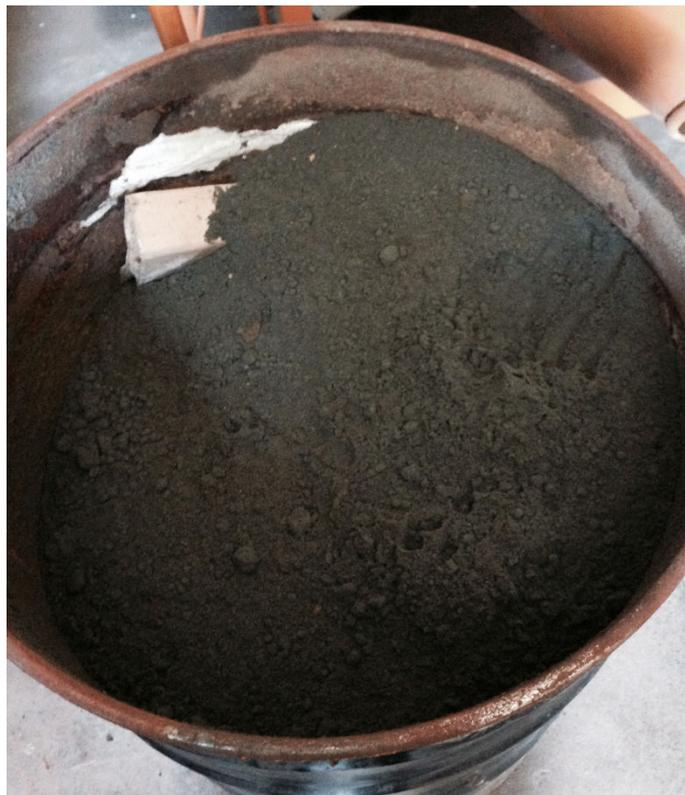
Figura 2.3 – Resíduo da mineração do cobre sulfetado.
