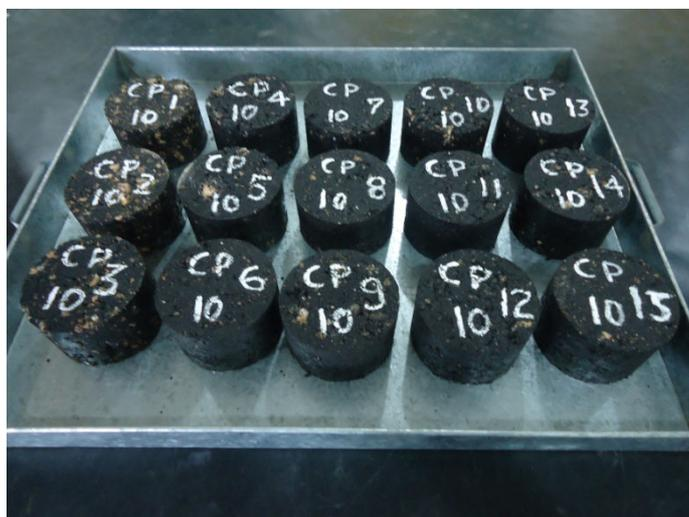
Figura 4.15 - Alguns dos corpos de prova confeccionados durante a dosagem.
