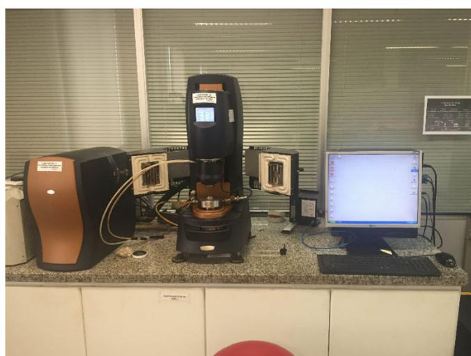
Figura 3.6 – Reômetro de cisalhamento dinâmico do Laboratório de Geotecnia da COPPE/UFRJ.
