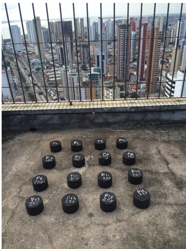
Figura 3.2 - Corpos de prova em exposição ao tempos.
