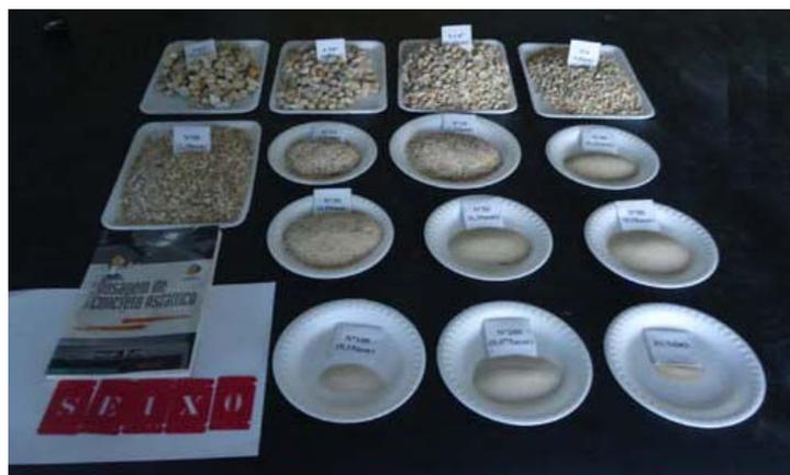
Figura 4.8- Foto do resultado da granulometria do seixo.
