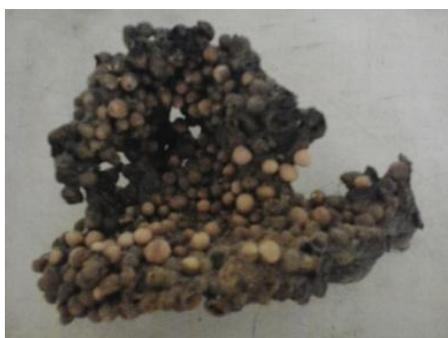
**Figura 4.8** - Aspecto das pelotas após sofrer o processo de sinterização durante a reação de combustão.
