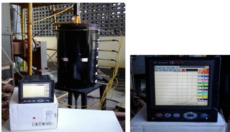
**Figura 3.9** - Paper Lass Register acoplado ao reator de combustão.
