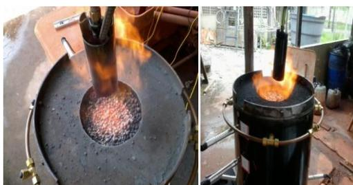
**Figura 3.8** - Ignição do combustível no reator de combustão.
