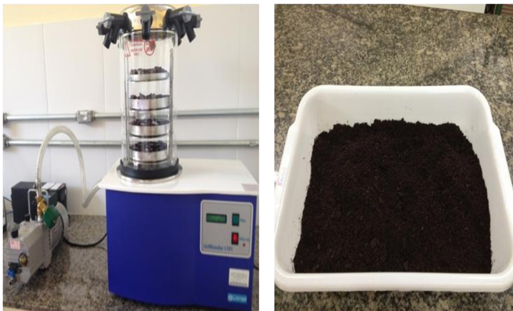
Figura 8 Liofilizador utilizado e polpa liofilizada obtida
