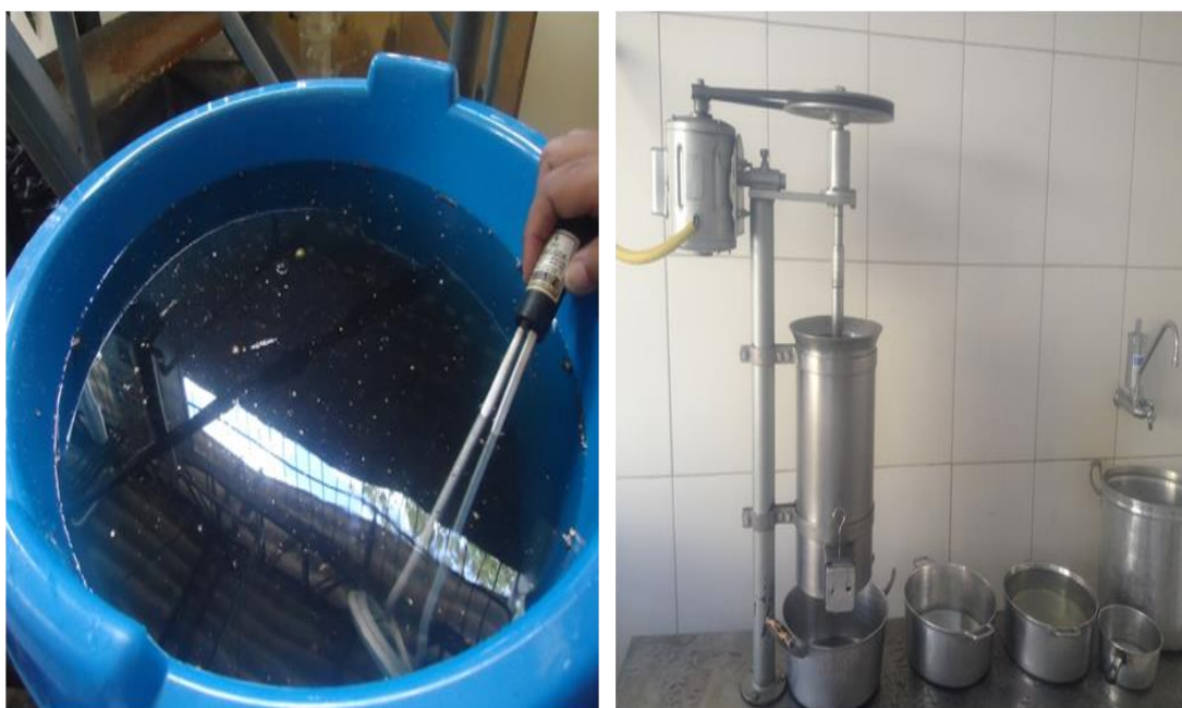
Figura 7. Amolecimento da polpa e despolpadeira de açai utilizada
