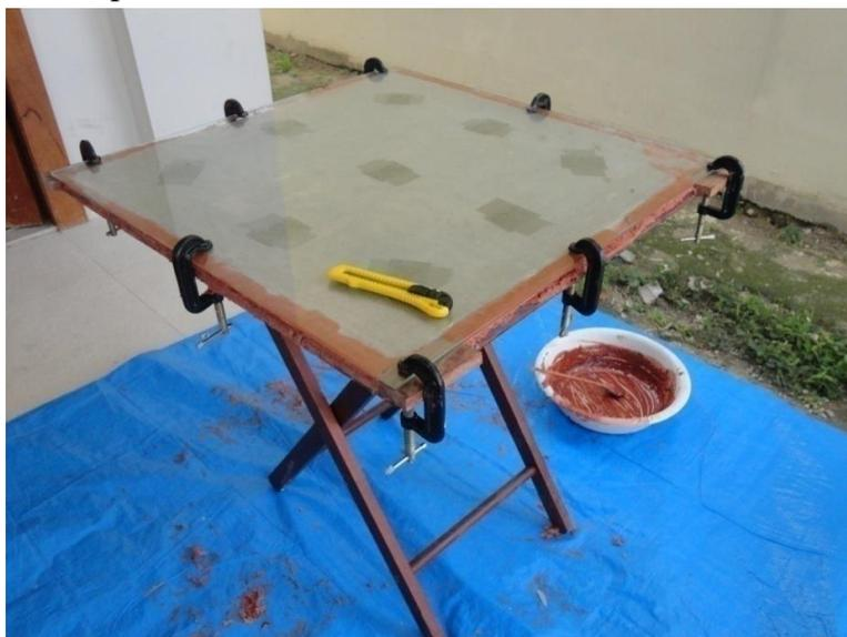
Figura 3.17 – Compósito na prensa para uniformização da espessura.
