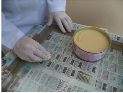
Figura 3.5 – Aplicação da cera desmoldante.
