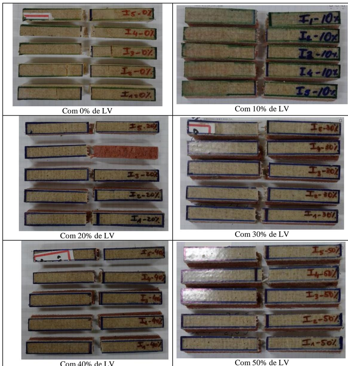
Figura 4.9 – Corpos de prova pós-ensaio de impacto Charpy.
