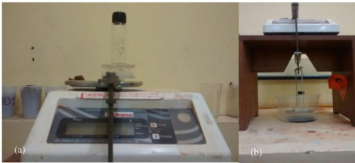
Figura 3.19 – Aparato para a determinação da massa específica aparente: (a) Obtenção da massa seca e da massa úmida do corpo de prova e (b) obtenção da massa imersa do corpo de prova.
