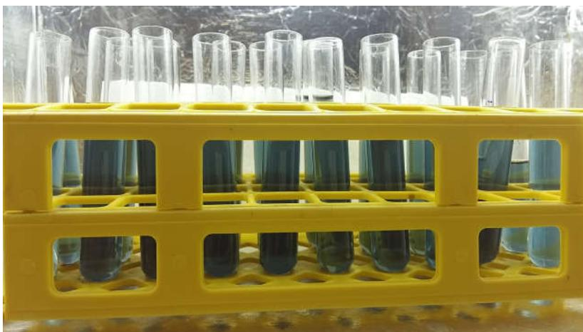
Figura 4.36 – Tubos de ensaio no interior de uma câmara, contendo amostras ao final dos ensaios de estabilidade à luz ( $t = 27$  dias)
