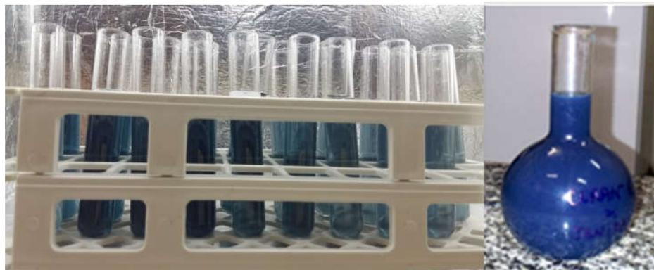
Figura 4.35 – Tubos de ensaio no interior de uma câmara (a esquerda), contendo amostras do corante na diluição compatível às análises espectrofotométricas (translúcidas), a partir da solução corante recém extraída (a direita), para o início dos ensaios (t=0)
