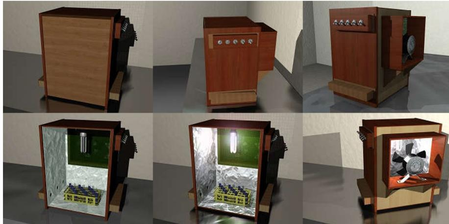
Figura 3.11 – Câmaras para testes de estabilidade à luz
