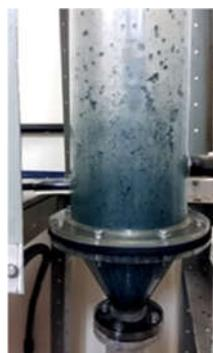
Figura 4.19 – Partículas inertes aderidas ao leito
