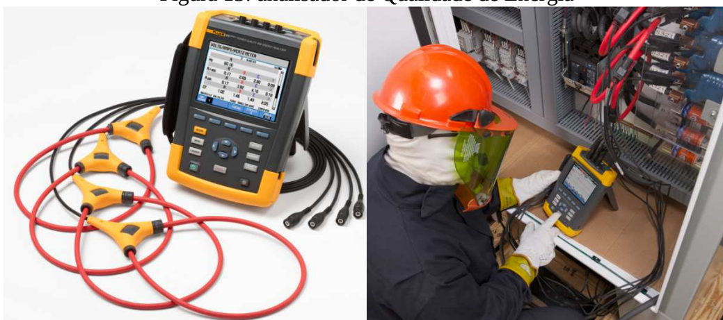
Figura 13: analisador de Qualidade de Energia
