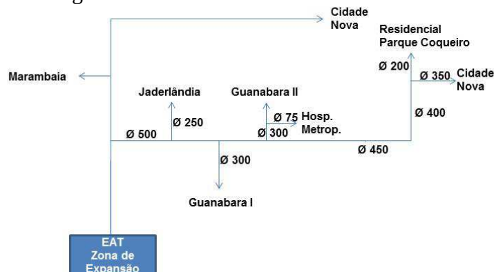
Figura 61: adutoras do Sistema Bolonha/ZE.
