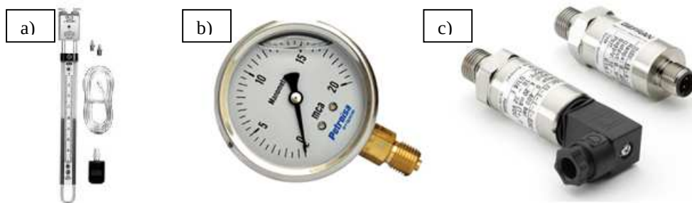
Figura 12: a) manômetro em coluna, b) manômetro mecânico e c) transdutor de pressão.
