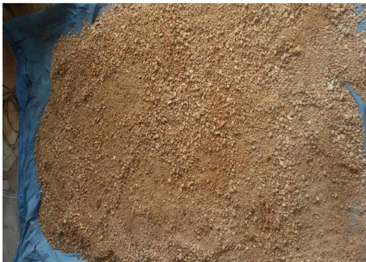
Figura 3.17: Agregado graúdo natural (seixo rolado) em pré-secagem.
