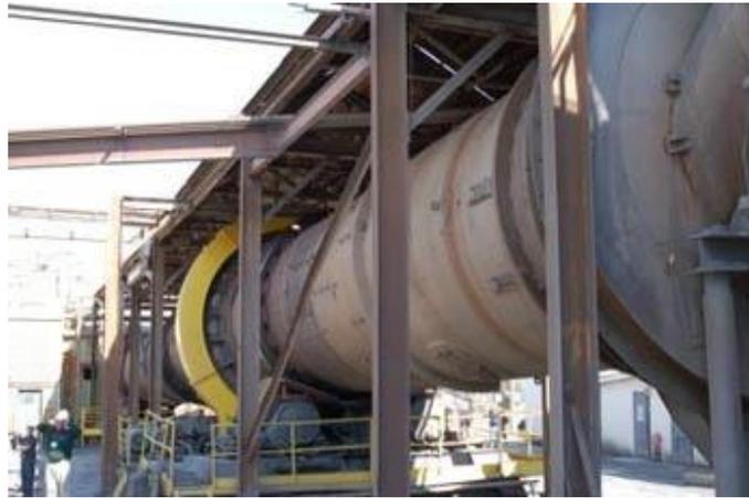
Figura 2.7: Forno rotativo
