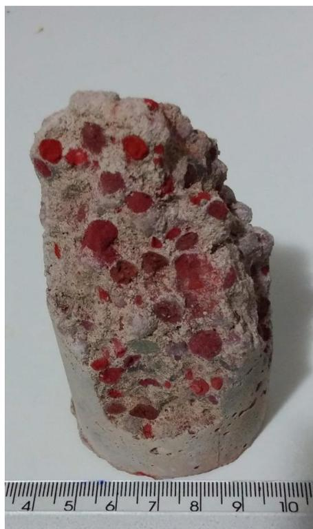
Figura 4.17: Corpo-de-prova (CAS) rompido com 28 dias.
