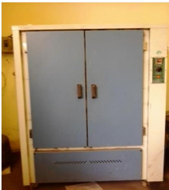
Figura 3.10: Estufa da marca Marconi, modelo MA 035/5 utilizada neste trabalho.
