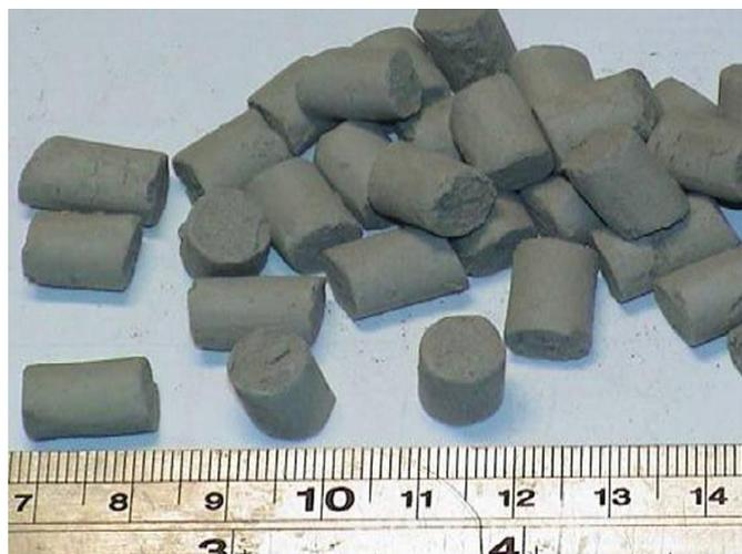
Figura 2.10: Lodo de ETA após peletização em extrusora
