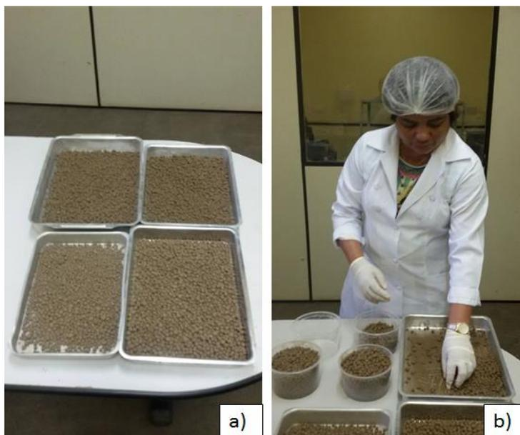
Figura 3.23: a) agregados após secagem em estufa; b) armazenamento dos agregados.
