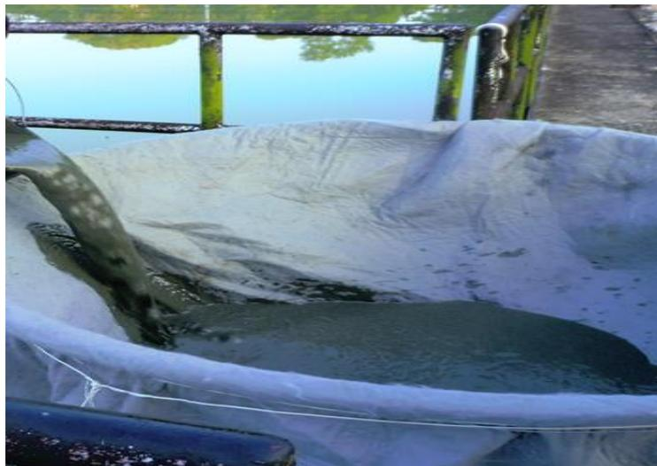
Figura 3.7: Lançamento das amostras de lodo em um dos reservatórios da UDL.
