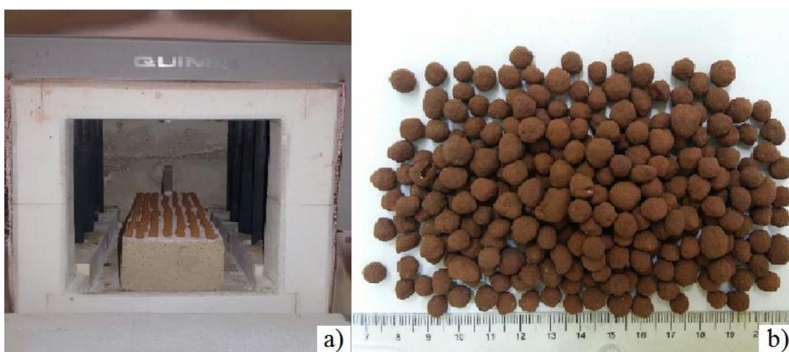
Figura 3.24: a) agregados no interior do forno elétrico antes do processo de queima; b) agregados após a queima.
