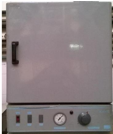
**Figura 4.3** – Estufa para aquecimento da solução de PVCP.
