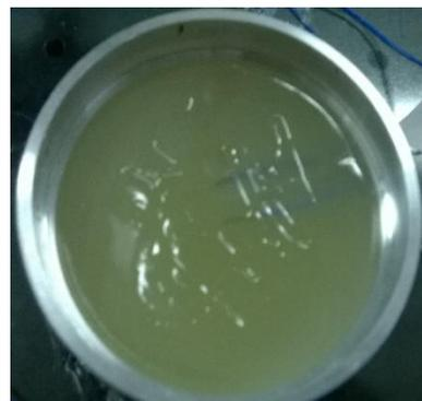
**Figura 4.5** – Phantom sintético moldado.
