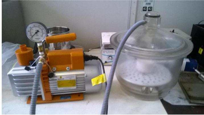
**Figura 4.2** – Remoção de bolhas de ar a vácuo da solução de PVCP.
