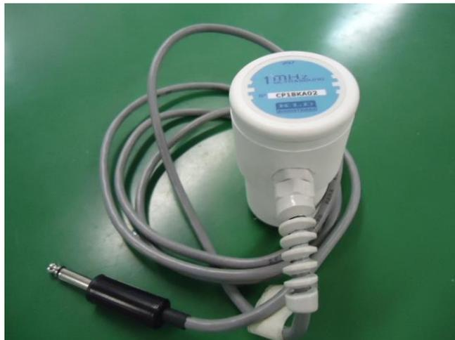
**Figura 3.2** – Transdutor ultrassônico de 1MHz. Fonte: KLD Biosistemas.
