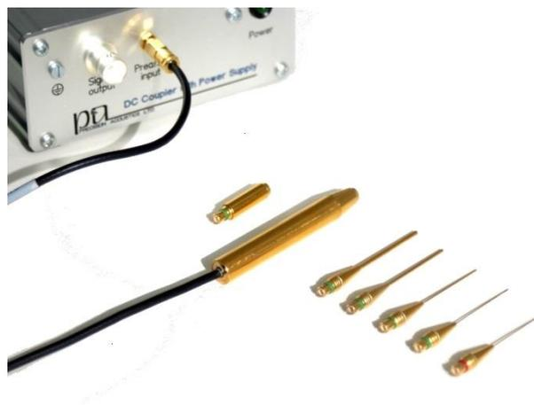
**Figura 3.7** – Hidrofone tipo agulha. Fonte: <http://www.acoustics.co.uk/products/needle>.
