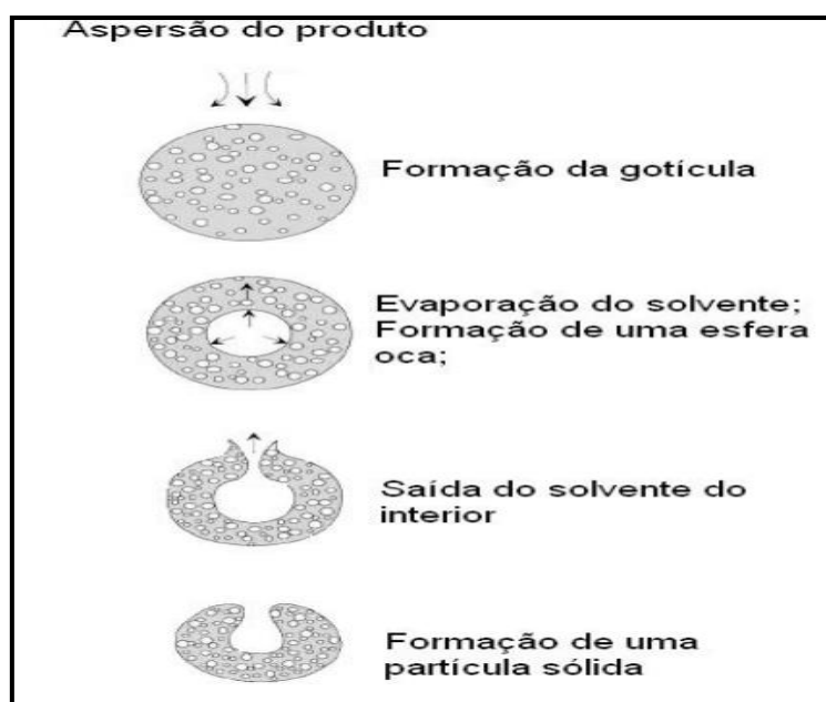
Figura 2.9 - Formação da microcápsula na secagem por spray dryer Fonte: CAO et al. , 2000
