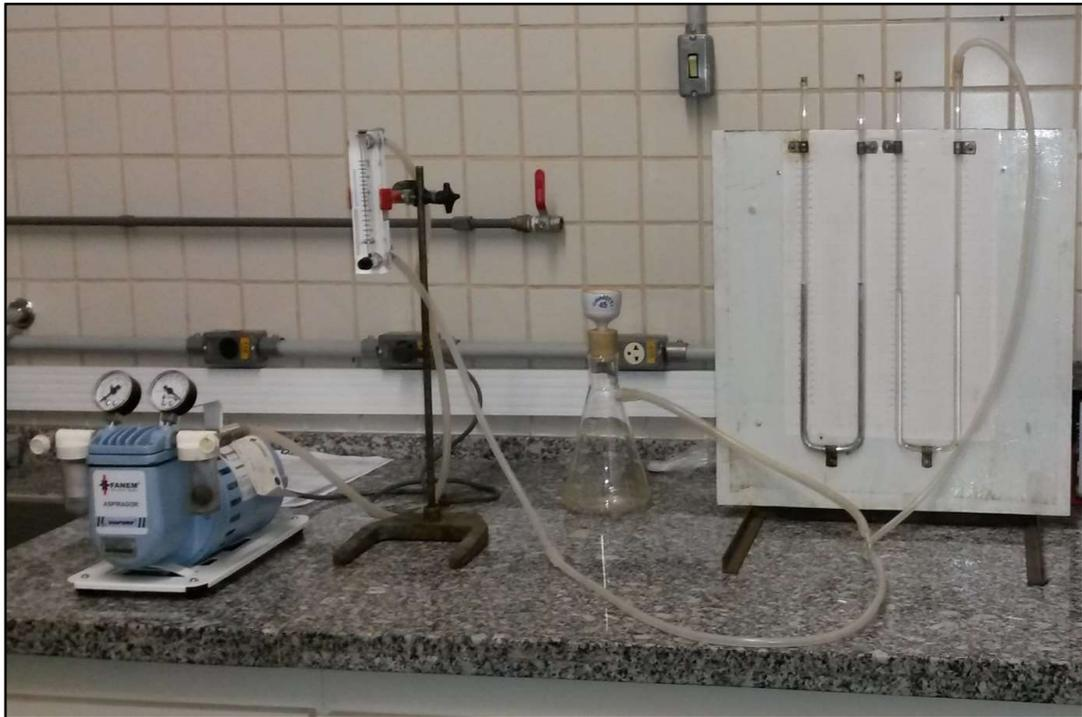
Figura 3.7 – Foto da unidade experimental de medição do grau de esfericidade das partículas minerais.
