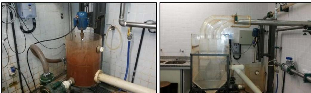
Figura 3.3 – Unidade de loop e sistemas de caixa de polpa e calhas distribuidoras.
