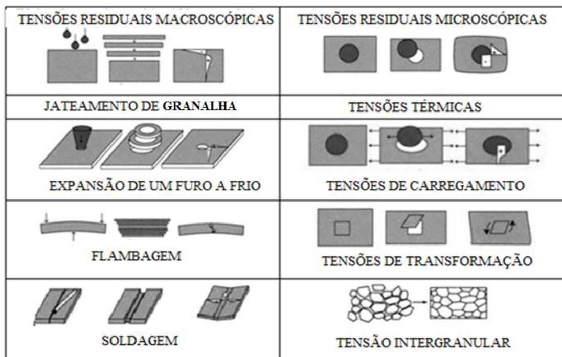
Figura 2.5 - Exemplos de algumas formas típicas de tensões residuais. Fonte: Adaptado de WITHERS e BHADESHIA, (2001a).
