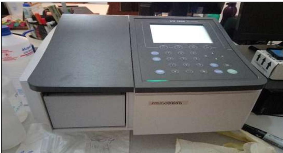
**Figura 3.6.** Espectrofotômetro/UV da marca Shimadzu (UV1800).
