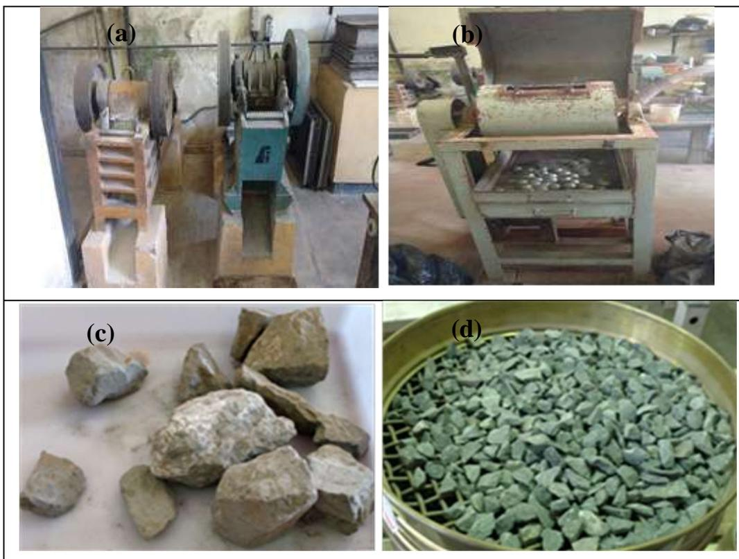
**Figura 3.2.** a) Britador de mandíbula e; b) Moinho de bolas; c) Granulometria original do minério; d) Granulometria após cominuição.
