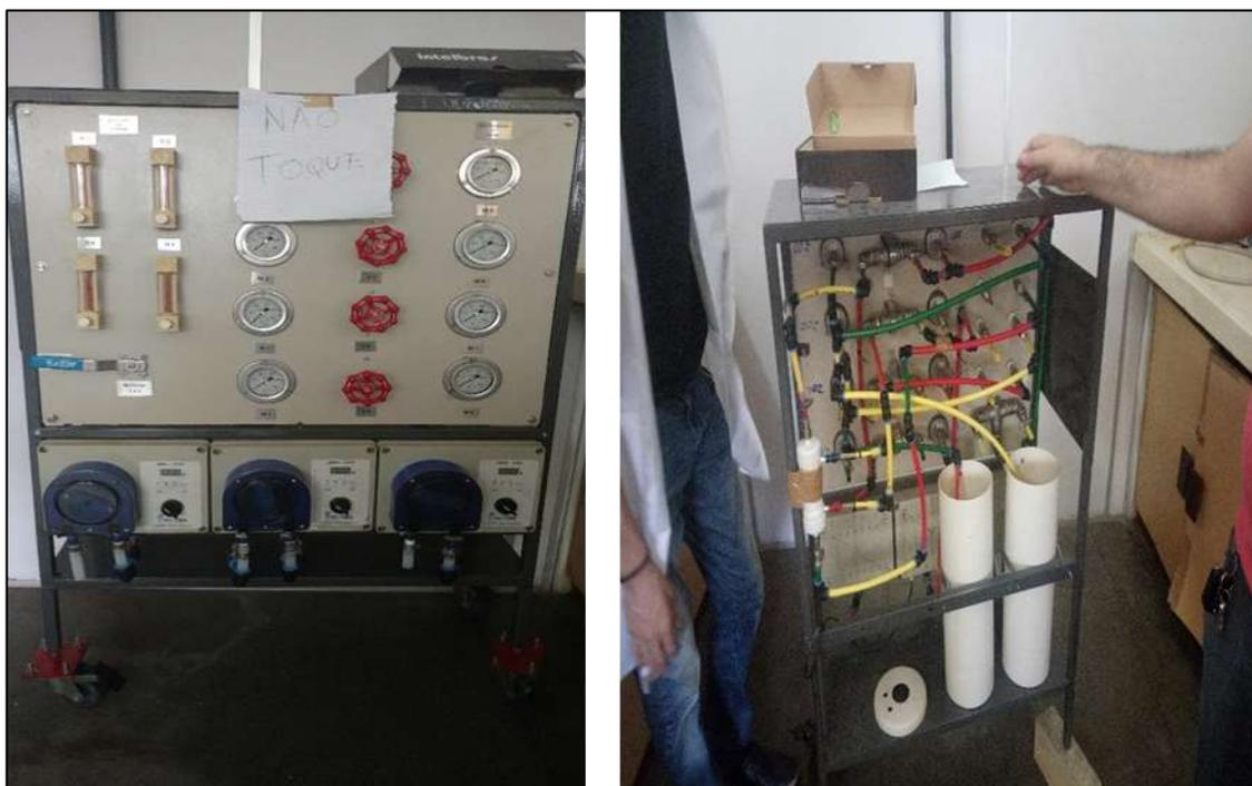
**Figura 3.11.** Sistema de contactor por membranas - PRODERNA/UFPA (vista frontal e posterior).
