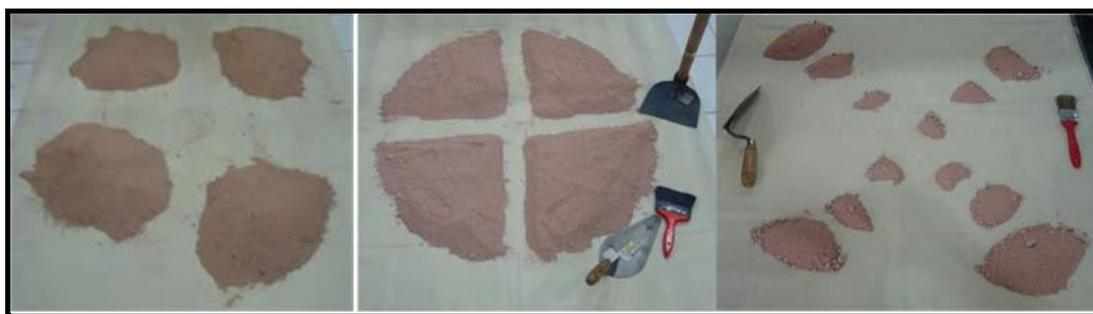
**Figura 3.11 - Procedimento manual para o quarteamento dos materiais.**
