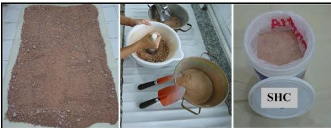
**Figura 3.10 – Solo SHC: Secagem ao ar, desagregado no almofariz e depositado no balde.**
