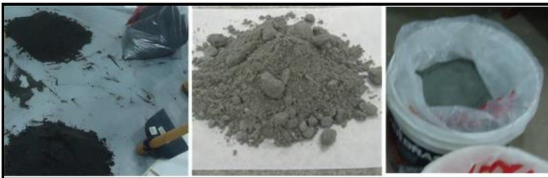
**Figura 3.9 – O RCS no processo de secagem ao ar.**
