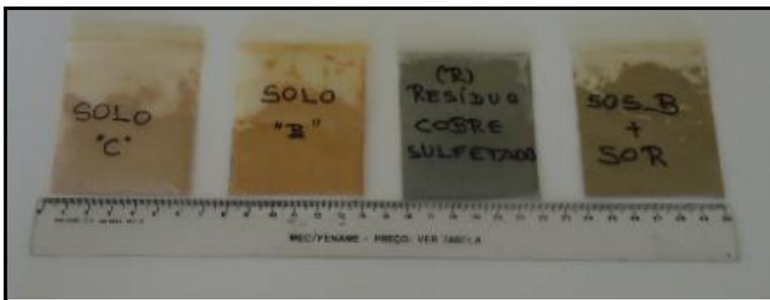
Figura 3.21 – Amostras dos materiais para análise DRX e pH.
