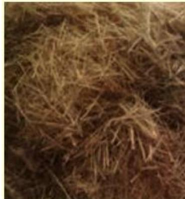
Figura 23 – Fibras de bananeira cortadas para determinação da massa específica.
