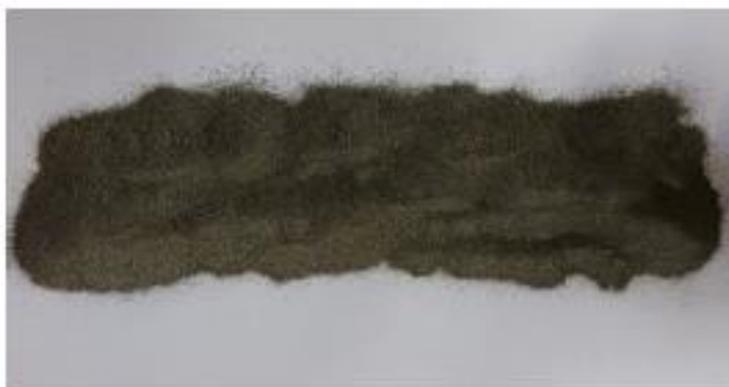
Figura 17 – Resíduo de flotação do processo de beneficiamento do minério de cobre.
