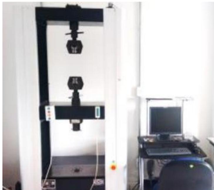
Figura 32 – Máquina de ensaio de tração.
