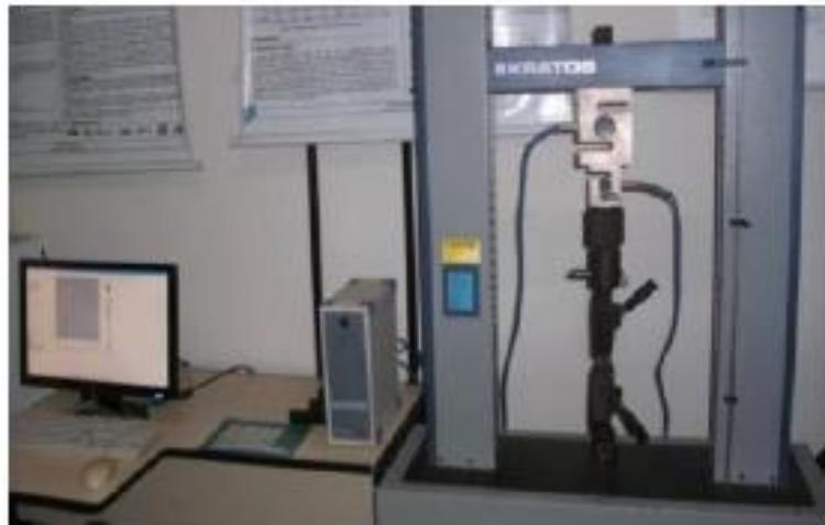
Figura 24 - Máquina de ensaio de tração marca KRATOS modelo IKL3.
