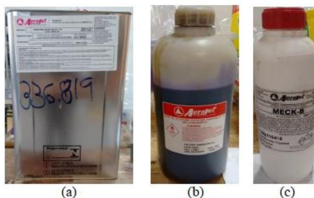
Figura 16 – Preparação do compósito: a) Resina poliéster insaturada; b) cobalto (acelerador); c) Iniciador MEK-P.
