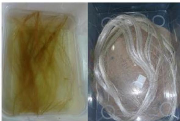
Figura 20 – Limpeza e armazenamento das fibras extraídas.
