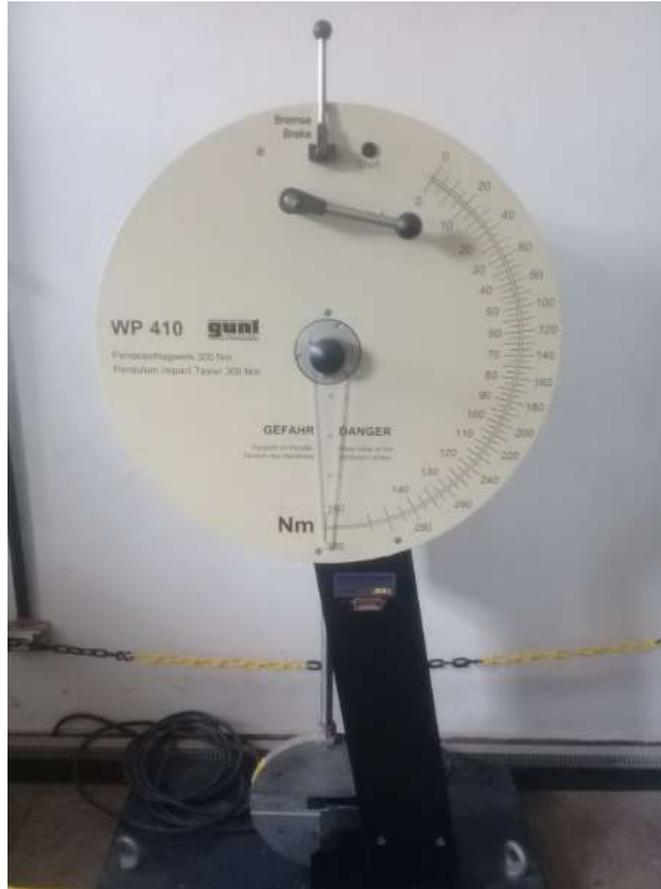
Figura 3.17 –Máquina de ensaio de resistência ao impacto.
