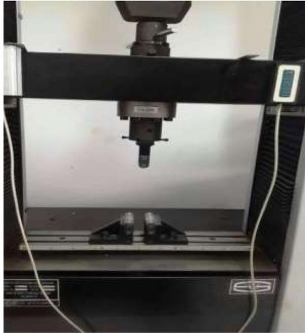
Figura 3.15 – Máquina para o ensaio de flexão.
