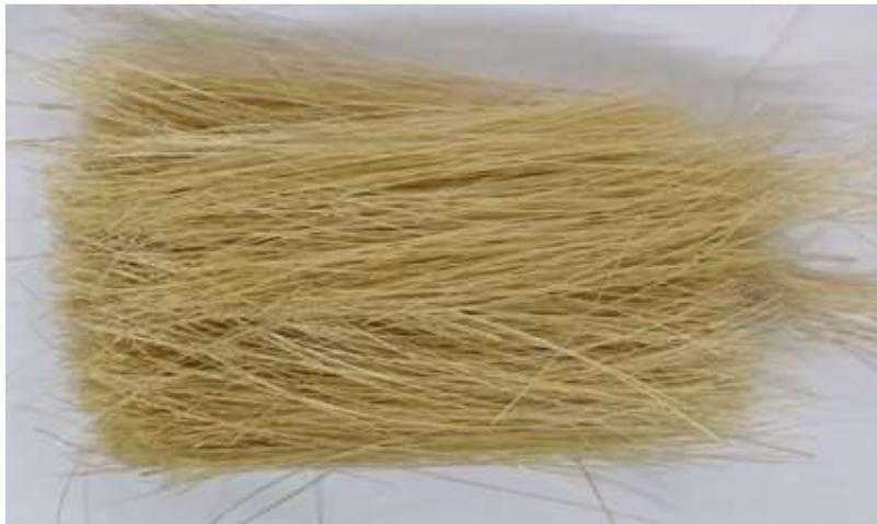
Figura 3.3 – Fibras de bambu dispostas
