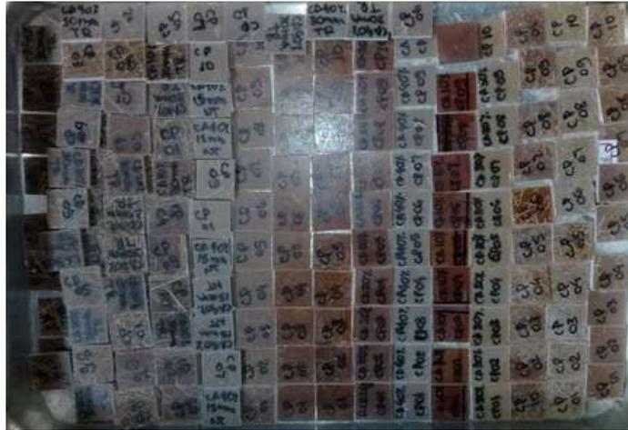
Figura 3.10– corpos de prova produzidos para caracterização física
