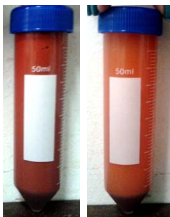
Figura 6. 5 – Antes e depois da centrifugação com 0,25 M HCl.
