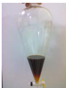
Figura 5. 3 – Formação de duas fases durante o período de repouso do processo de desacidificação por extração líquido-líquido.
