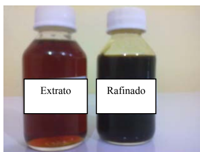
Figura 5. 4 – Fase extrato e fase refinado obtida no processo de desacidificação.
