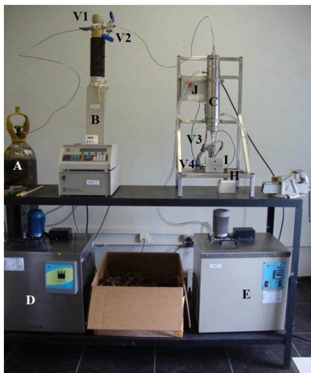
Figura 3. 1 Módulo experimental utilizado nas extrações com fluido pressurizado
