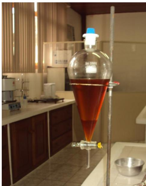
Figura 3.14 Separação e lavagem do biodiesel
