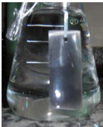
Figura 4.3 Corpo de prova de aço carbono em meio de NaCL (3% - 25°C) no instante inicial da imersão
